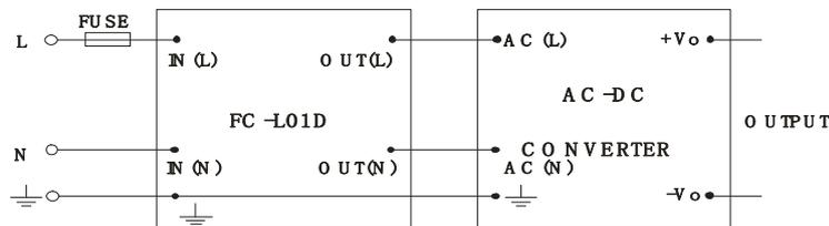
FUSE (保险管)：由于不同电源模块输入电流的差异，保险管的推荐值请参考电源模块的技术手册上关于保险管推荐值的说明。
