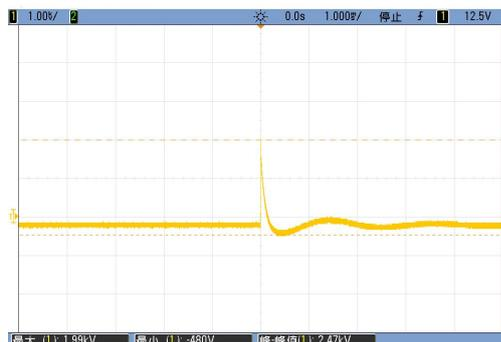
输入端电压波形(差模 1.99KV)
